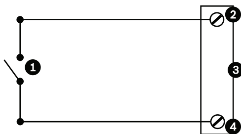
Figure 10.4: N.O. - Connexions normalement ouvertes non supervisées
