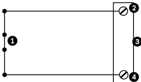
Rysunek 10.5: N.C. Połączenia nienadzorowane rozwiernie
