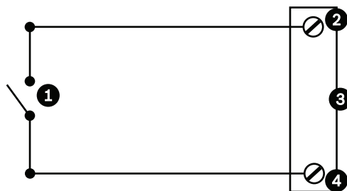
Rysunek 10.4: N.O. - Połączenia nienadzorowane zwierne
