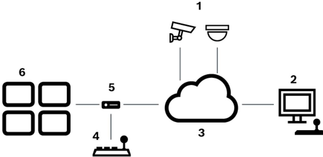
**Figure 5.2:** Scénario 2 : clavier IntuiKey de Bosch connecté à un décodeur
