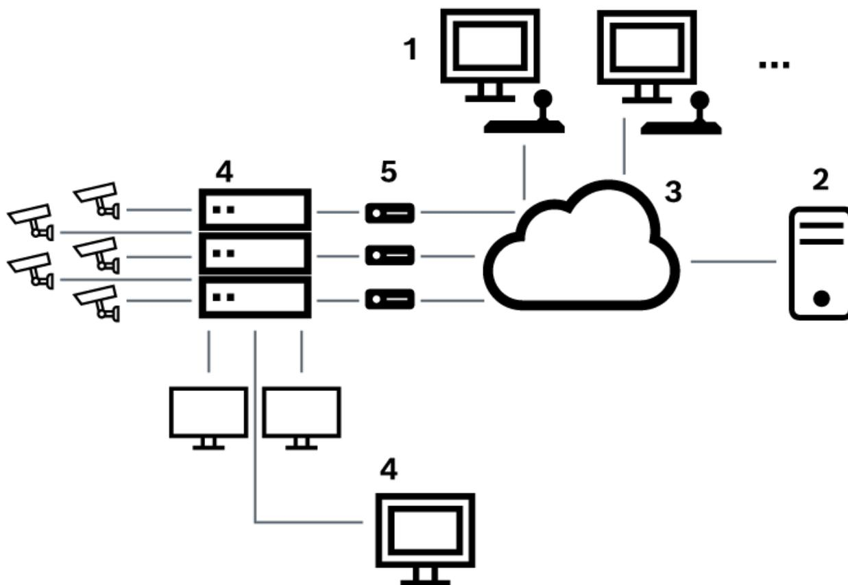
**Figura 5.4:** Ligação remota do Bosch Video Management System a um computador matricial Allegiant Bosch
