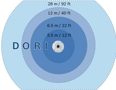
当安装在 3 米 (10 英尺) 高的位置时, 360°型摄像机在这四个级别下分别具有如下覆盖半径:
